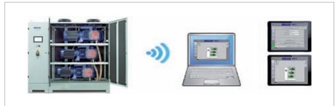
Prostredníctvom dodatočného prístupového bodu možno zároveň zobrazovať a prevádzkovať HMI aplikáciu aj na tablete.
