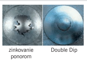
Obr. 4 Porovnanie prílnavosti ochranného povrchu
